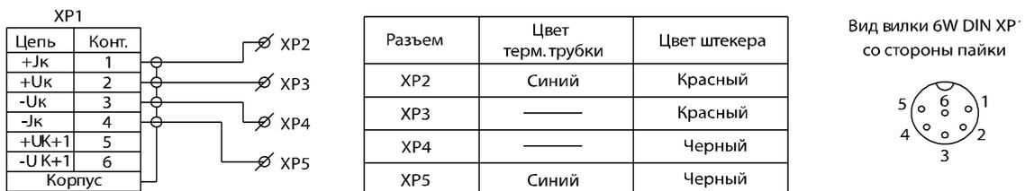
Рис. 8. Схема электрическая принципиальная кабеля отведения для тетраполярного режима.
