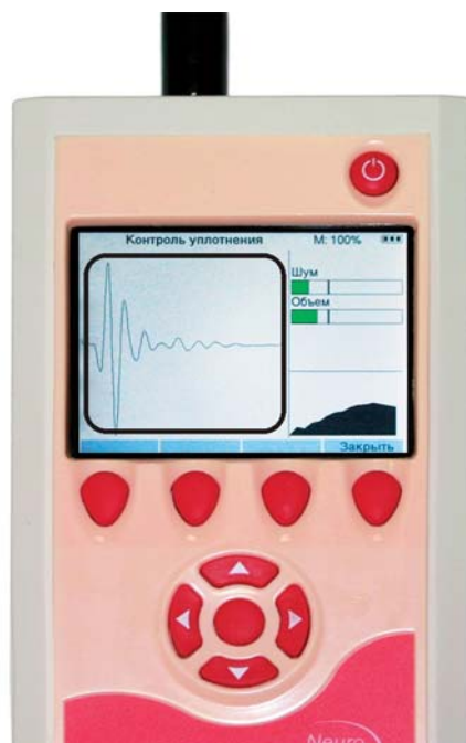
Рис. 51. Окно проверки установки зонда. Форма стимула.
