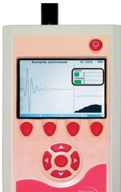
Рис. 53. Окно проверки установки зонда. Шкалы объема и шума.
