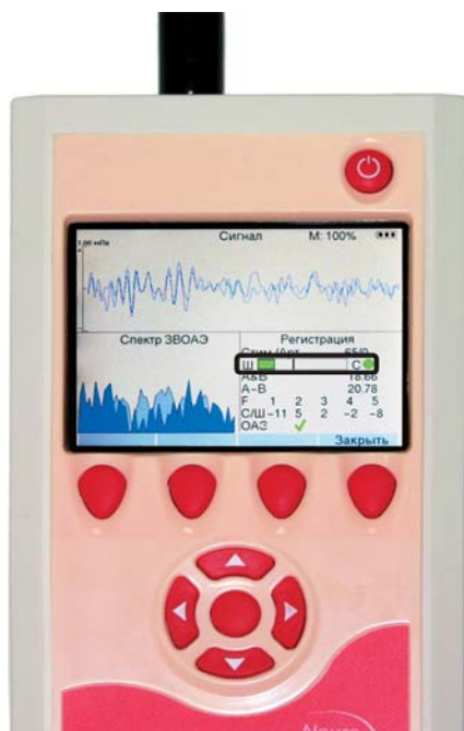
Рис. 44. Шкала текущего уровня шума и индикатор стабильности зонда.
