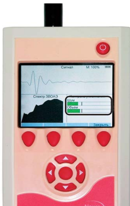
Рис. 39. Окно проверки установки зонда. Шкалы объема и шума.
